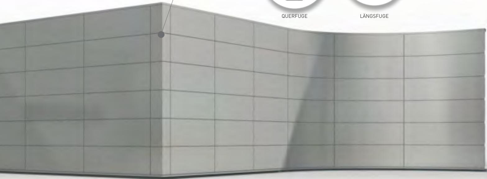
Das Qbiss One **Fassadenelement** besteht aus zwei verzinkten und hochwertig beschichteten Stahlblechen mit einem nicht brennbaren Mineralfaserkern. Diese Komponenten bilden zusammen ein festes Element mit Elementstärken von 80 mm bis 240 mm.
